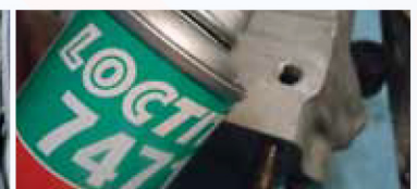
Superficies inactivas como: aluminio, acero inoxidable, magnesio, zinc, recubrimientos electroquímicos, cadmio, titanio y otros.
