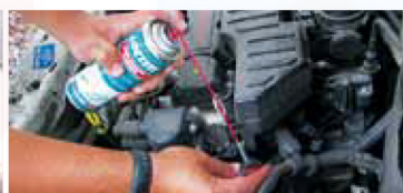
Limpieza de fusileras, sensores, distribuidores, bornes de batería, capuchones de bujías y contactos eléctricos en general.
