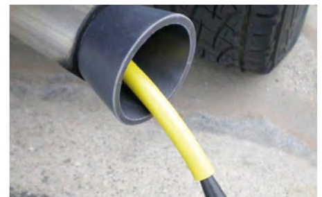
También se pueden encontrar fugas en sistemas de escape.
