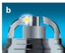
Electrodo lateral – electrodo central.
