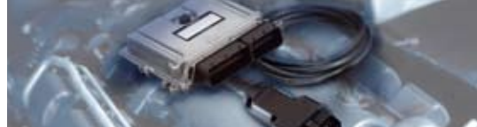
Diagnóstico de la Unidad de Comando
